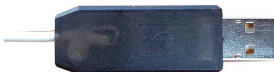
Рис. 4 Адаптер USB-RS485 FTDI
